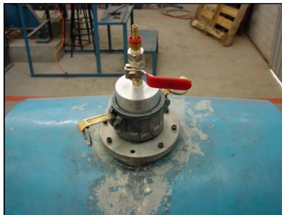
Fig. 2.11 Válvula para introducir gas, acoplado a la tapa del molino.
