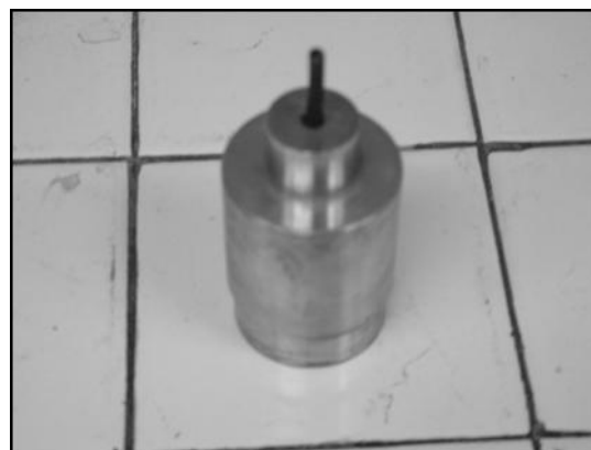
Fig. 2.9 Cilindro escalonado para extracción de muestras.
