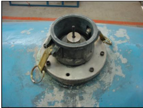
Fig. 2.10 Tapa del molino de bolas con el cilindro escalonado.
