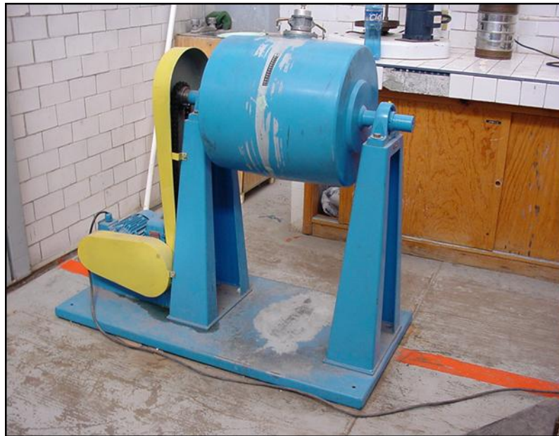
Fig. 2.1 Molino de bolas de acero inoxidable utilizado en el presente trabajo.
