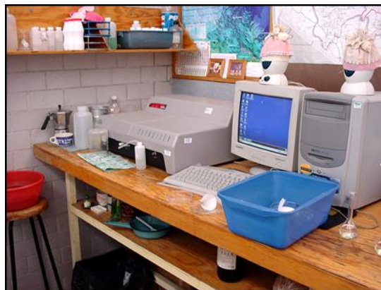
Fig. 2.3 Analizador de tamaño de partícula.
